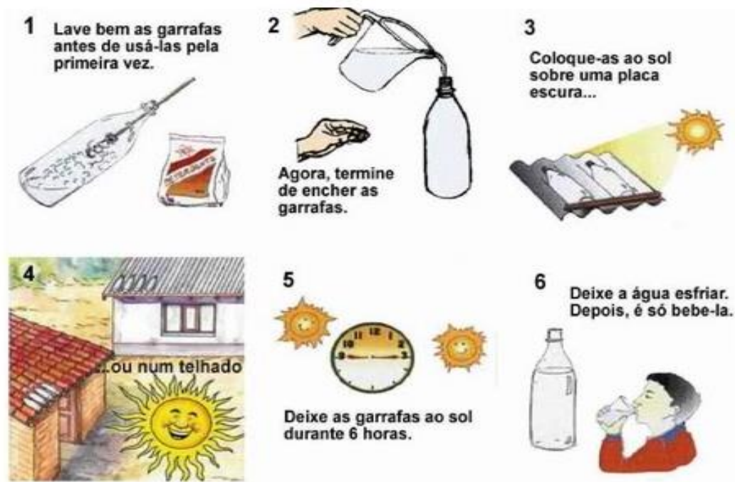
Figura 3.10 - Etapas de funcionamento do método de desinfecção solar SODIS (Fonte: Instituto Federal Suíço de Ciências e Tecnologias Aquáticas, 2013)
